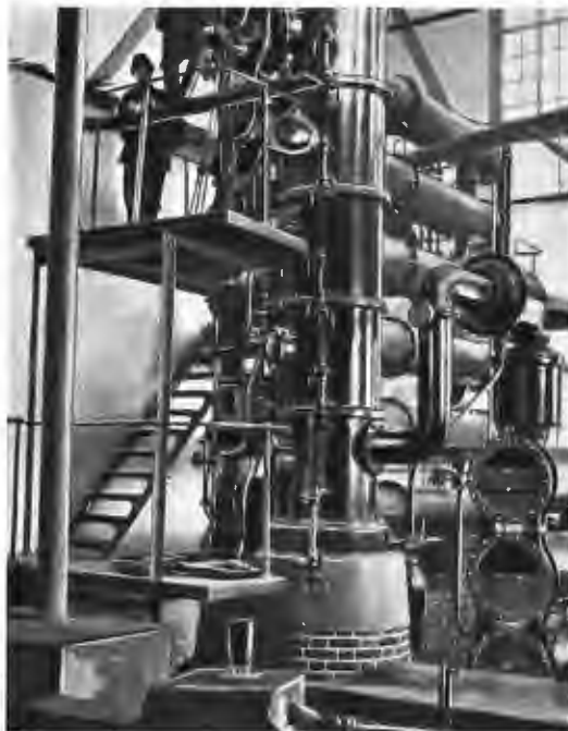
Дистилляція питьевой воды для рабочихъ въ Баку.
