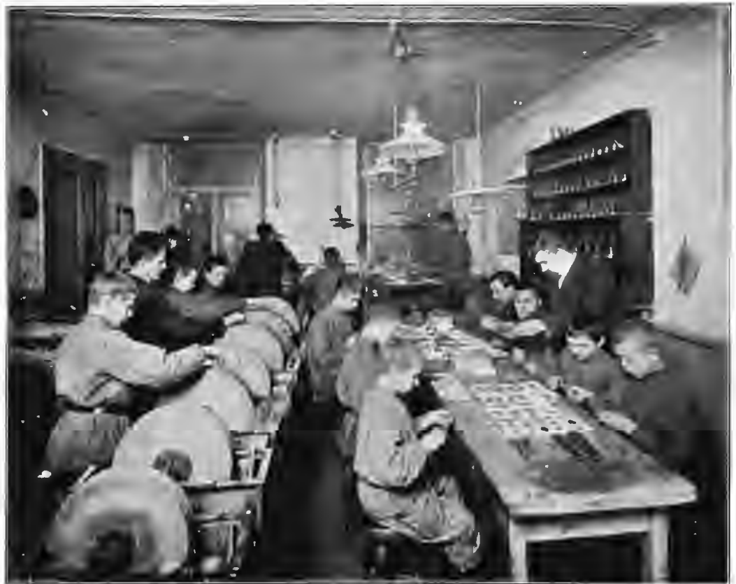
Общій видъ шлифовальной мастерской. Отдѣлъ обточки оптическихъ стенокъ и вставки стенокъ въ оправы.
